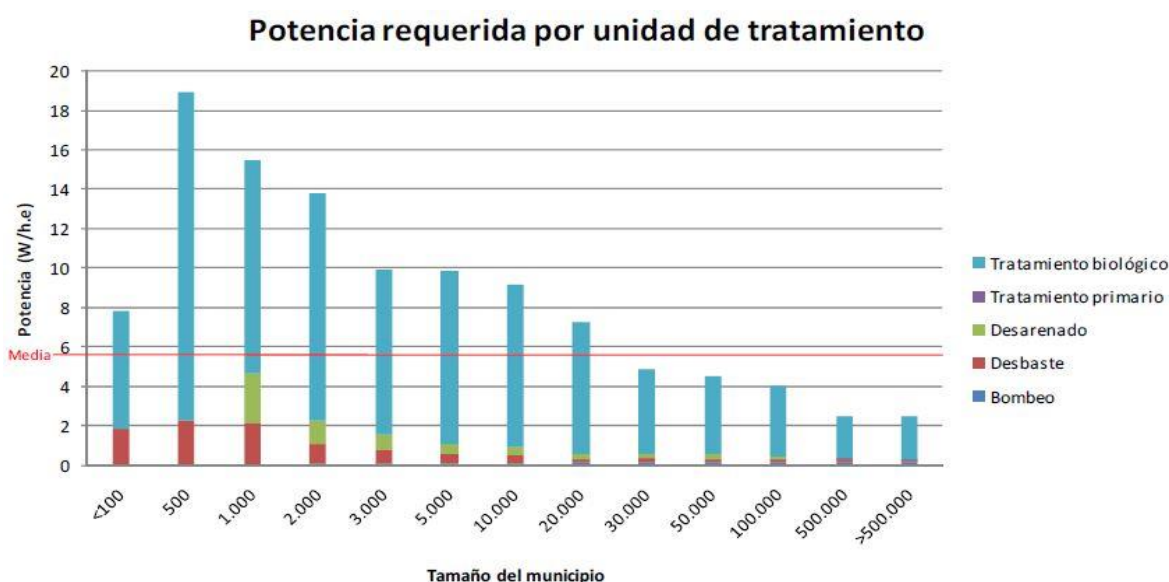
Figura 12. Potencia requerida por unidad de tratamiento para distintos tamaños de EDAR expresado en W/h.e.; Tomado de Fundación Canal, 2017
